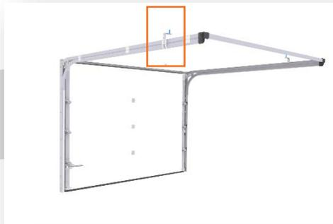
Dans le cas où le plafond est plus haut, alors il est possible d'obtenir des suspentes plus grandes avec une Ht = 500 mm par lot de 2 pièces *SUSPENEVER500X2*
